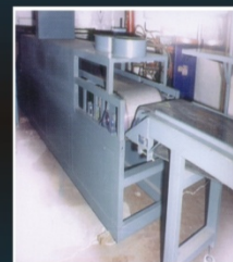
ESTUFA COM ESTEIRA METÁLICA TEMPERATURA PARA SOLDAGEM DE COMPONENTES ELETRÔNICOS
