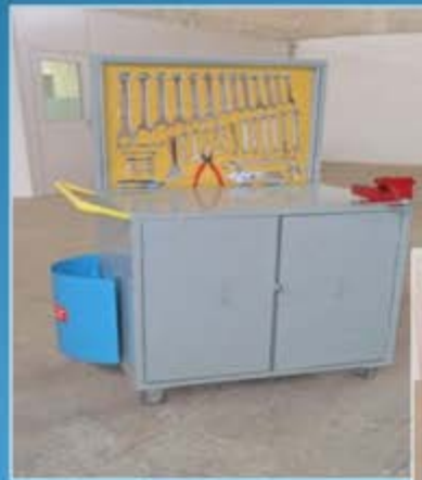
RACK PARA MÊCANICOS EM GERAL COM DIMENSÕES (L80 Cm X P60 Cm X A90 Cm).
