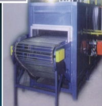
FORNO A GÁS GLP 550° COM ESTEIRA TRANSPORTADORA EM INOX PARA CURAR PEDRAS TIPO EXPORTAÇÃO
