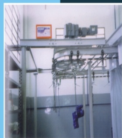
TRANSPORTADOR AÉREO CAPACIDADE 230 KG OIR GANCHEIRA PARA LINHA DE PINTURA
