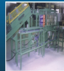
TRANSPORTADOR DE PARAFUSOS ALIMENTADOR VIBRATÓRIO E PARA MÁQUINA ROSQUEADEIRA
