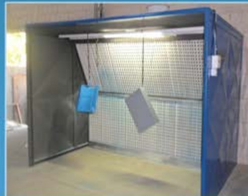
CABINE DE PINTURA LIQUIDA COM SISTEMA DE FILTRO PLIS E MANTA (PE) COM EXAUSTOR. (L 3 mt.X P 2 mt. ALT. 2 mt..
